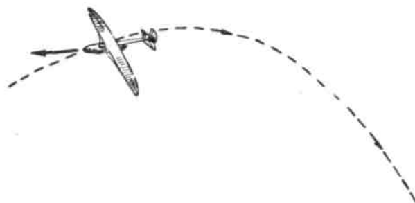
Рис. 156. Планер в воздушной волне.
